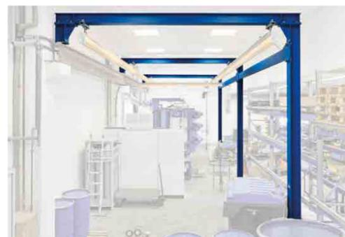
Las estructuras con porterías, rígidas a la flexión, permiten placas base pequeñas que se fijan mediante tacos al suelo.
